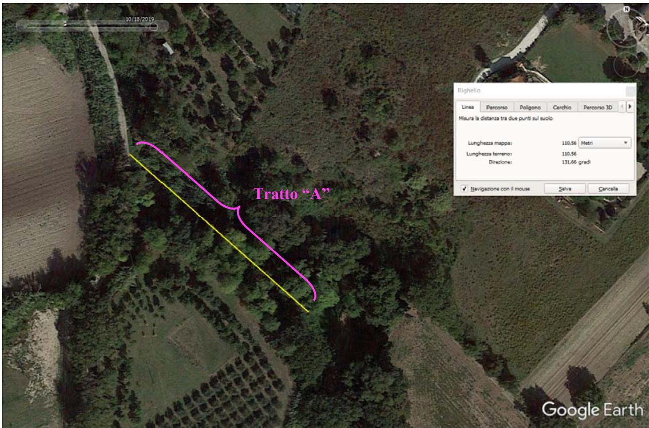
Fig. 2: tratto "A" per il quale viene rilasciato il nulla osta alla trinciatura delle del canneto e della vegetazione a rovo sulla sponda destra, ed eventuale rimozione di legname e/o depositi fangosi localizzati nei punti in cui dovesse risultare necessario per il ripristino della ordinaria sezione di deflusso
